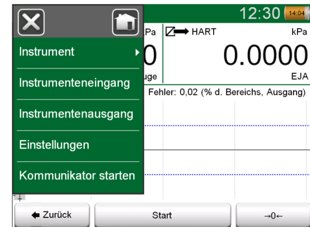
Menü im dokumentierenden Kalibrator bei der Kalibrierung eines HART-Instruments.
