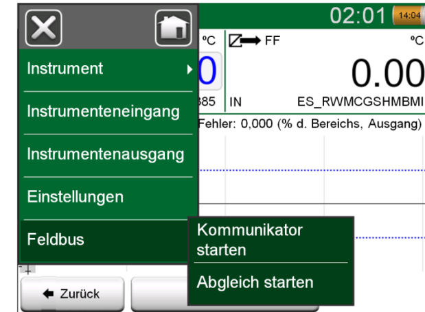
Menü im dokumentierenden Kalibrator bei der Kalibrierung eines Feldbus-Instruments.
