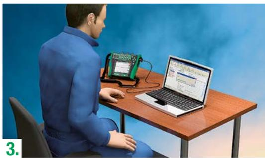
Téléchargez les procédures d'étalonnage et d'inspection de maintenance vers un calibrateur de documentation ou un appareil mobile.
